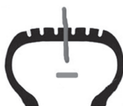
Неправильне встановлення джгута
